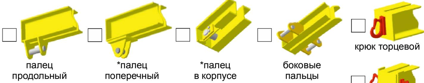
\* На элементах, отмеченных звездочкой могут быть смонтированы скобы такелажные, крюки и иные приспособления.
